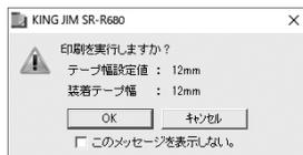
装着テープ幅 : 「テプラ」本体に装着されているテープカートリッジのテープ幅が表示されます。
